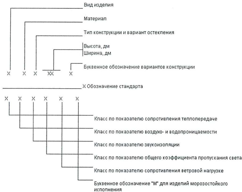
Пример условного обозначения блока оконного:
